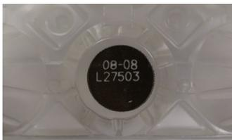
Der einzelne Lasercodierer auf der Packbahn der Dutzendkartons wurde so ausgelegt, dass die Position des Markiersystems über die Breite der Packbahn angepasst werden konnte, um die aktuellen Codieranforderungen des Kunden zu erfüllen und um für künftige Kartonausführungen flexibel zu sein. Diese Lasergeräte sind in der Lage, 35 Verpackungen pro Minute zu bedrucken.
